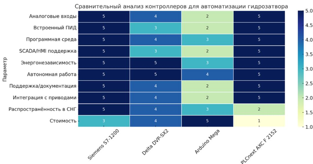
Рисунок 4 – Визуальное сравнение технических характеристик контроллеров для систем управления расходом воды
