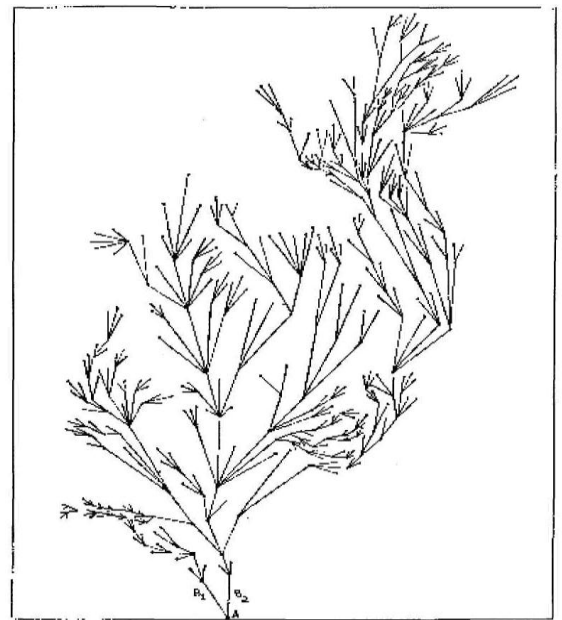
Рис.3. Абстракция рельефа современной дельты Амударьи в виде отрезков прямых линий (второй этап идеализации по рис. 1, А)
