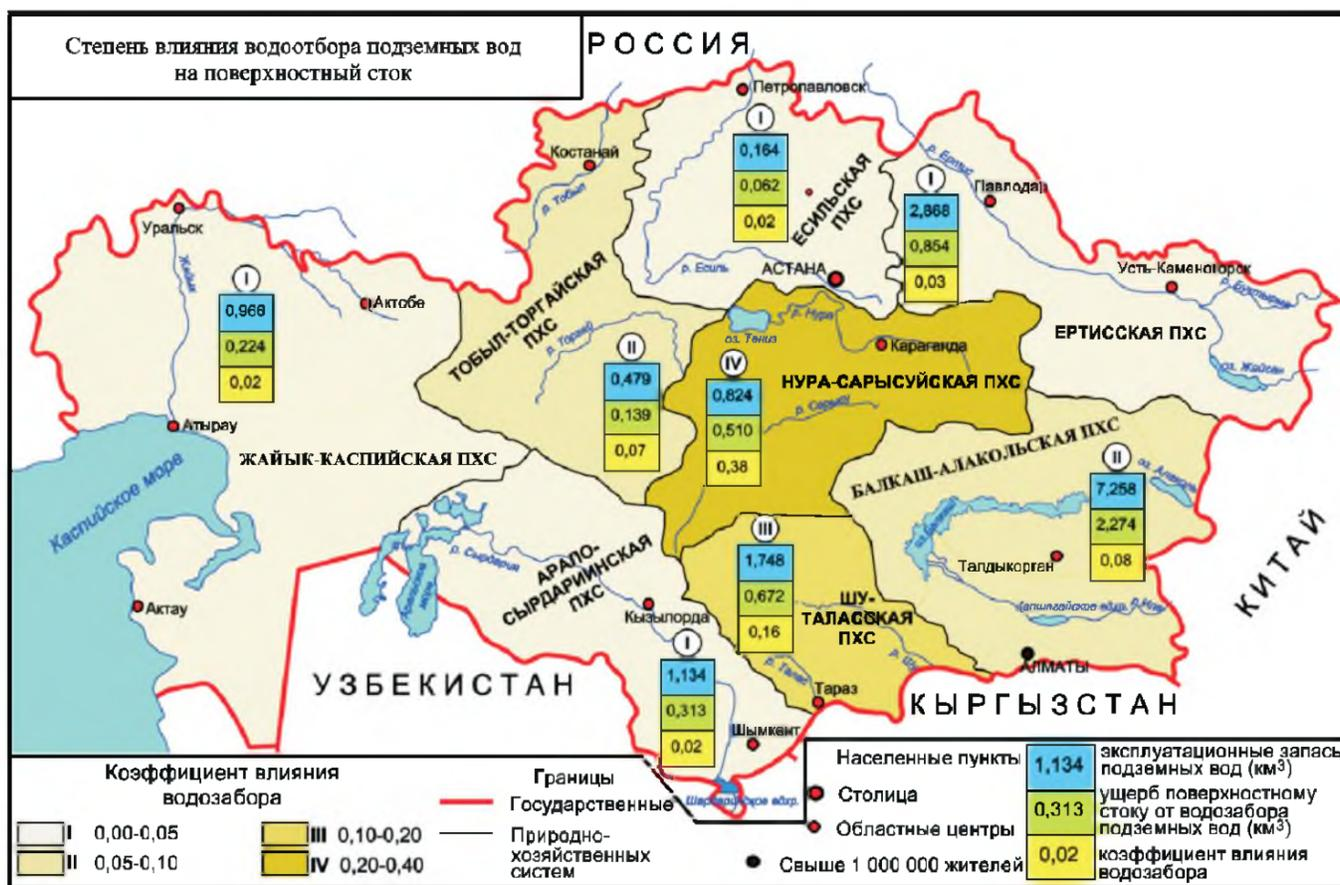
Рис. 7. Влияние водоотбора подземных вод на поверхностный сток
