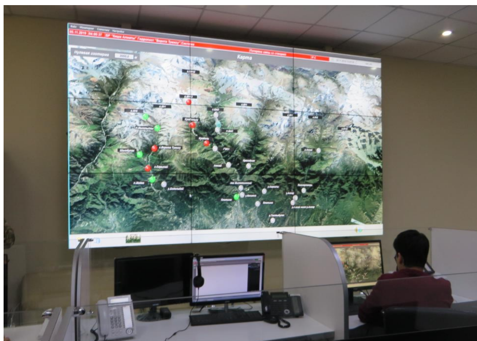
Рисунок 3 – Видеостена со станциями автоматизированного мониторинга селевой опасности в ситуационном зале Департамента по чрезвычайным ситуациям г. Алматы
