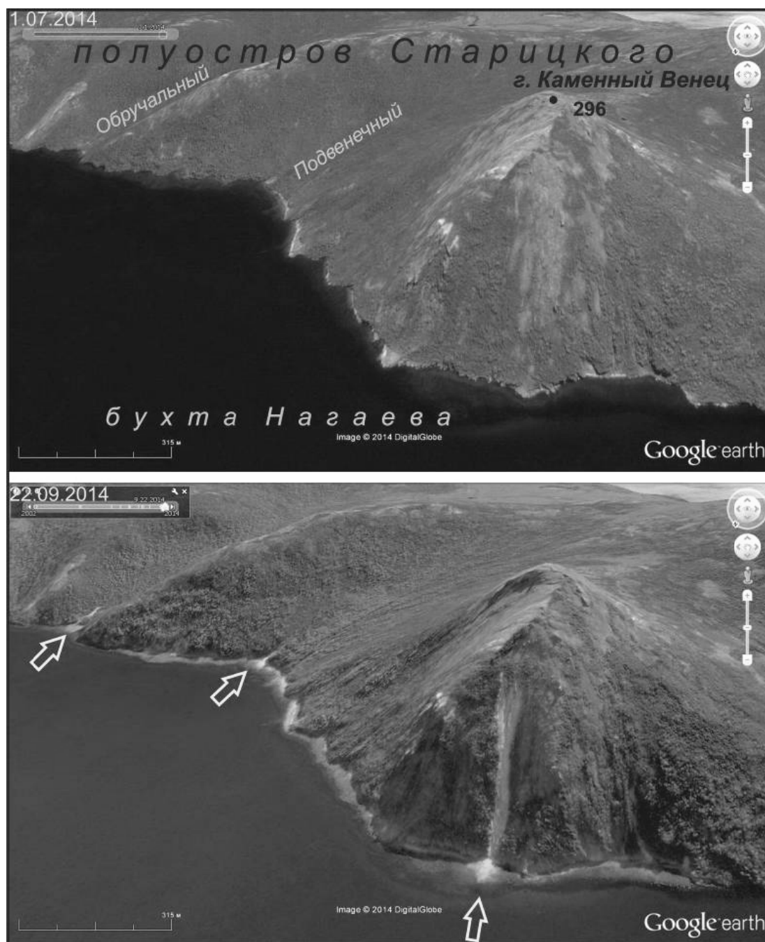
Рисунок 4 – На южном берегу бух. Нагаева со склона горы Каменный Венец в море сошел крупнейший после ливней 2014 г. оползень (точнее, обвал-оползень или каменная лавина с признаками селея). Длина этой структуры вместе с нишей отрыва – около 480 м по падению склона. Менее крупные оползни возникли вблизи устьев ручьев Обручальный и Подвечный, а также у ручьев Холодный и Берёзовый (Б. П. Важенин [9])
