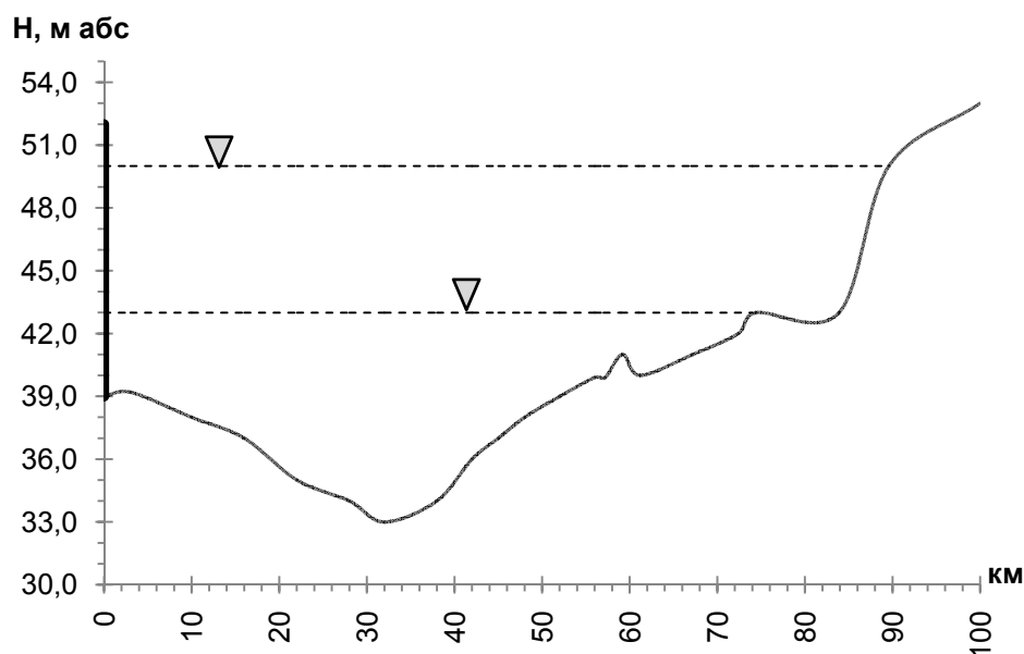
Рисунок 4 – Продольный профиль САМ. Вариант I. Одноуровневая плотина
