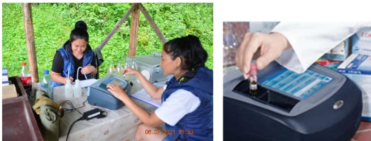
Рисунок 2 – Измерения на спектрофотометре DR 3900
