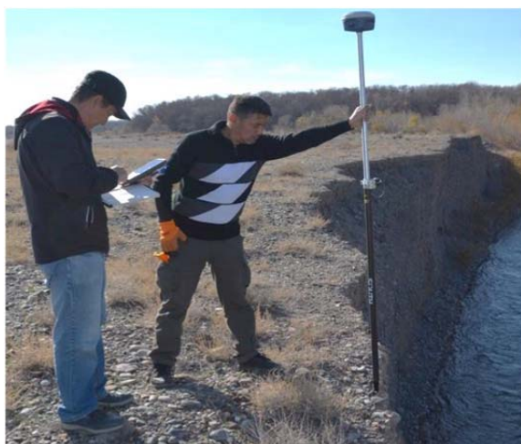
Рисунок 9 – Определение точных координат развития русловой и боковой эрозии русла р. Шарын на мониторинговом участке № 8
