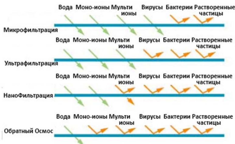
Рисунок 1 – Способность различных типов мембран очистить исходную воду от различных примесей
